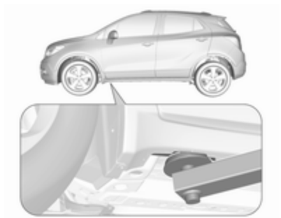
Anhebestelle für vorderen Arm der Hebeplattform am Unterboden.
