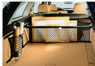
Das multifunktionale 3-D-Netz kann z. B. als v-förmiges Transportnetz oder als horizontaler Laderaumteiler genutzt werden.
