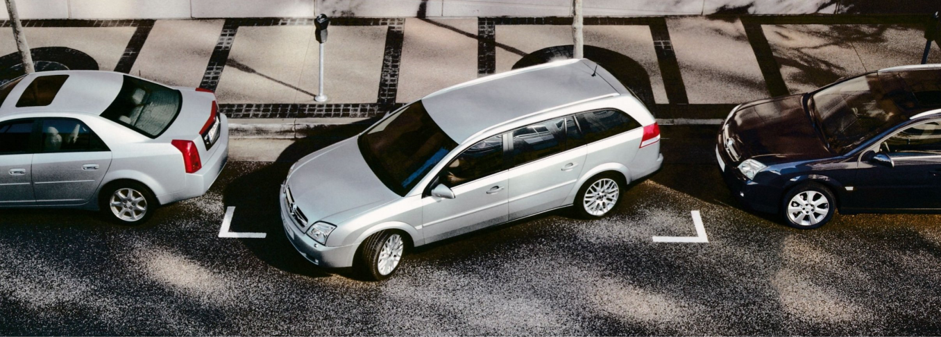
Der Parksensor warnt den Fahrer mit einem akustischen Signal vor Hindernissen hinter dem Fahrzeug.
