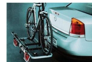
Der neue Heckfahrradträger lässt sich bequem auf der Anhängerzugvorrichtung montieren.
