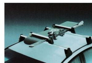
Der aerodynamische Aluminium Skiträger für den Transport von Ski und Snowboards.
