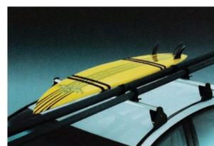
Für den perfekten Ritt auf den Wellen: der Surfboardträger mit Masthalterung und Schnellverschluss.
