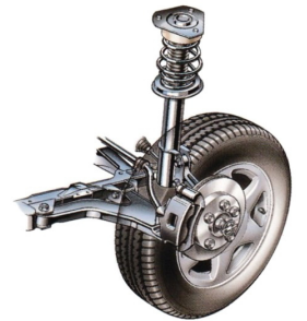
Die Sintra-Lenkpräzision durch die McPherson-Vorderachse ist ein wichtiges Element der aktiven Sicherheit.
