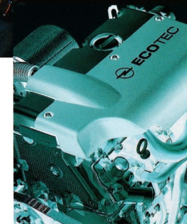
Links: Opel 4-Ventil-Technik mit zentraler Zündkerzenposition sorgt für effiziente, saubere Verbrennung. Rechts: Laufruhiger, elastischer 2.0 16V DI ECOTEC-Diesel mit 60 kW/82 PS.
