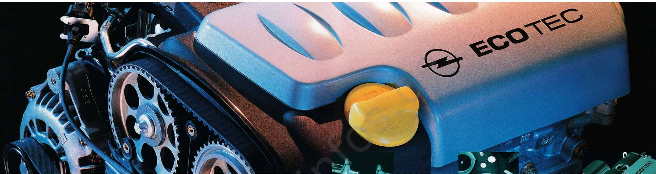
Gegenläufige Ausgleichswellen reduzieren im 2.0 16V ECOTEC (100 kW/136 PS) Vibrationen und Geräusche.
