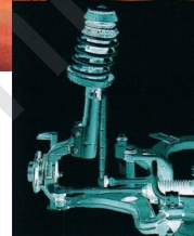
Die Vorderradaufhängung: McPherson-Federbeine mit DSA-Charakteristik für spurstabiles Bremsen in kritischen Situationen.
