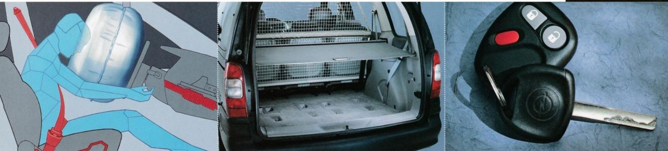
*Full Size Airbags für Fahrer und Beifahrer in Kombination mit pyrotechnischen Gurt-schloßstraffern und Sitzrampen bilden den optimalen Insassenschutz.*
