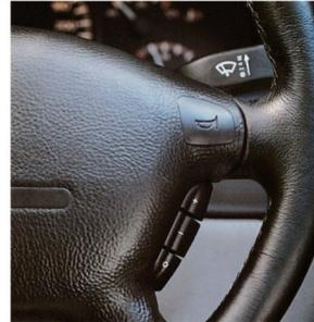
Höheneinstellbares Lenkrad mit Radio-Fernbedienung. (Im CD serienmäßig.)
