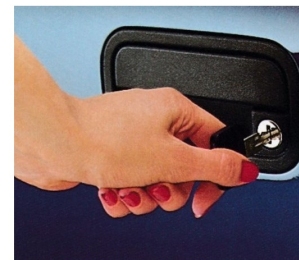
Zentralverriegelung mit Diebstahlsicherung und abschließbarem Handschuhfach. Verriegelt Türen, Tankdeckel und Heckraumklappe.
