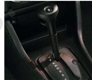
Elektronisch gesteuerte Opel 4-Gang-Automatik mit drei Fahrprogrammen. (Mit Neutral Control bei 2.0 16V und 1.8 16V).
