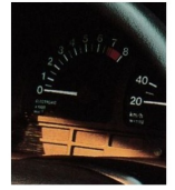
Der Drehabmesser gibt zuverlässige Infor- mationen für wirt- schaftliches Fahren.
