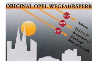
Die elektronische Wegfahrsperrung unterbricht mindestens drei der zum Fahren notwendigen Stromkreise von Zündung, Anlasser, Elektrischer Benzinpumpe, Motorelektronik und elektrischer Benzinpumpe. Das System ist in Deutschland versicherungsrechtlich als Diebstahlschutz anerkannt. Nicht lieferbar bei Diesel- und Turbodieselmotoren.
