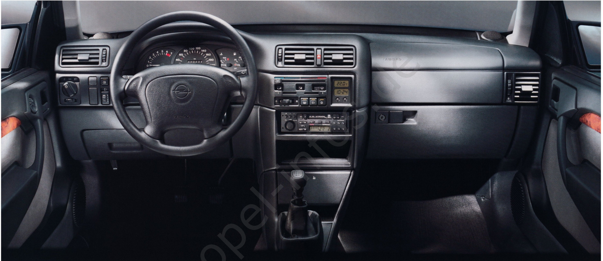
Das Cockpit des Opel Vectra CDX mit Full Size Airbag für Fahrer und Beifahrer. (Klimaanlage Sonderausstattung.)
