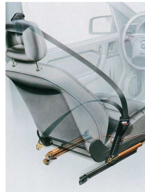
Das Vectra-Aktivgurt-System mit Gurtstraffer, höhenstellbaren 3-Punkt-Sicherheitsgurten vorn und hinten und in die Sitzstruktur integrierten Sitzrampen.
