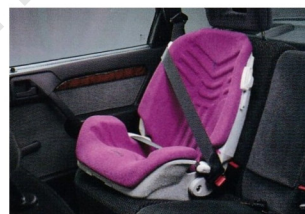
Opel Kindersicherheitsystem (als Reboard-System mit Hosenträgergurt und Sitzkeil).
