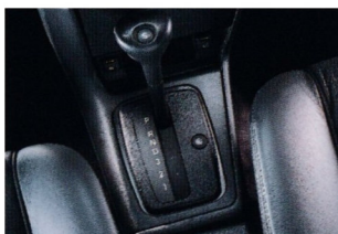
Vollelektronische 4-Gang-Automatik mit den Programmen „Power“, „Economy“, „Winter“.
