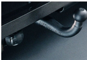
Abnehmbare Anhängervorrichtung, TÜV-Eintrag nicht erforderlich.
