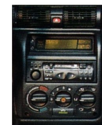
Multi-Info-Display. Opel Check-Control-System, Bordcomputer-Info, Radio-Funktionen und Uhr auf einen Blick.
