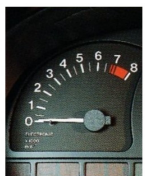
Instrumententafel. Die Instrumente inklusive Drehzahlmesser arbeiten mit Durchlichttechnik.
