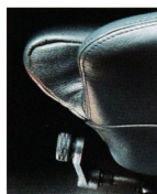
Sitzhöhereinstellung. Der Sportsitz auf der Fahrerseite ist in der Höhe stufenlos einstellbar.
