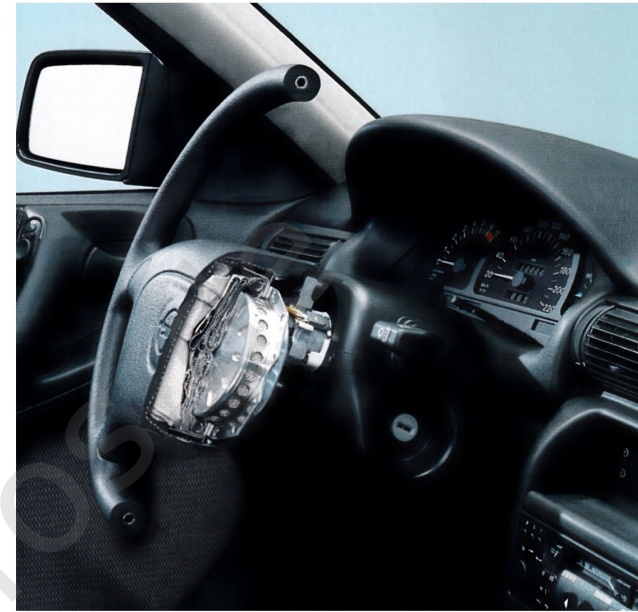
Der zusammengefaltete Airbag im Pralltopf des Lenkrades.
