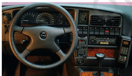
Abbildung zeigt nachträglich eingebautes Telefon.
