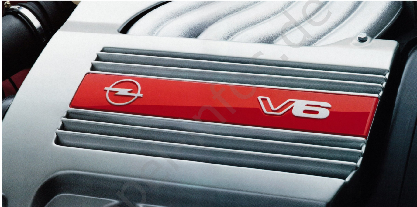
Der V6-Motor, 24 Ventile, 2,5 Liter, 125 kW (170 PS), lieferbar ab März 93.
