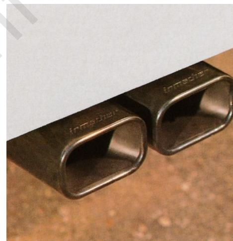
Nachschalldämpfer mit rechteckigem Doppel-Endrohr.
