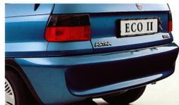
Durch die Einbauchung im hinteren Stoßfänger wird eine verbesserte Luftabströmung bezüglich der Luftströmungen unterhalb und seitlich des Fahrzeugs erzielt.
