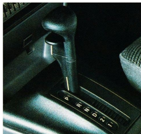
Automatlåda. Opels berömda automatlåda med fyra växlar och tre valbara körprogram: Economy – för normal ekonomisk körning. Winter – för start och körning på slippriga underlag. Power – för sportig körning med snabb acceleration.
