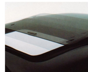
Das Sonnendach Topslider, manuelle Betätigung, 17 33 005, elektrische Betätigung, 17 33 006 (o. Abb.), läßt sich bis über die Mitte der Dachöffnung schieben.
