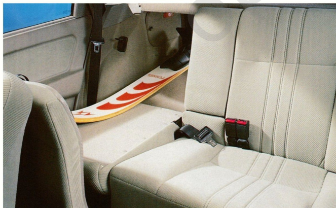
Asymmetrisch geteilte, umklappbare Rücksitzbank mit Durchladeeinrichtung.
