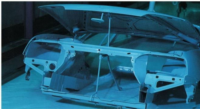
Die partielle Verwendung von verzinkten Stahlblechen, eine spezielle Rostschutzgrundierung, Phosphatierung und kataphoretische Tauchgrundierung, die Abdichtung von Schweißnähten, Fugen und Bördelkanten und ein
