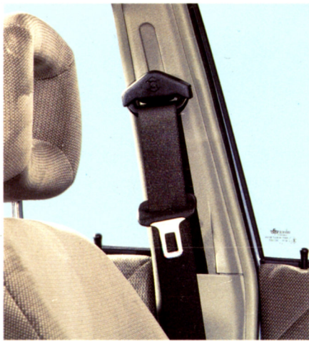
Links oben: Die Instrumententafel des Kadett und die Doppelbedienanlage. Sie ist auf Wunsch direkt ab Werk erhältlich. Rechts oben: Der Kadett ist auf Wunsch auch mit Anti-Blockier-System lieferbar. Eine weitere Steigerung der aktiven Sicherheit - bei einer Vollbremsung wird das Blockieren der Räder verhindert. Links unten: Die Sicherheitsgurte vorne und hinten sind höhenverstellbar. Rechts unten: Zweiter Innenspiegel für den Fahrlehrer.
