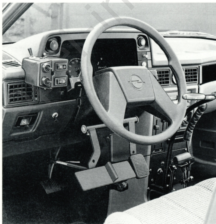
Rechts unten: Der Rollstuhl wird im Heck des Spezialkadett mit Gurten am Boden verankert. Links: Alle Bedienelemente im Cockpit werden den individuellen Bedürfnissen und dem Grad der physischen Behinderung angepasst. Hier: Vorverlegung der Pedale und Linear Hebellenkung.
