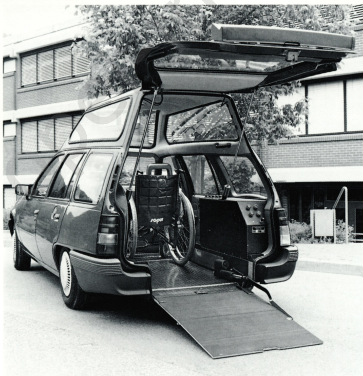
Oben: Entsprechend der DIN Norm besitzt der Kadett für Fahrdienste eine zweite Tür auf der rechten Seite und für die Begleitperson einen Klappsitz, der sich ganz herausnehmen läßt. Links unten: Handbedienung von Bremse und Gas und Drehknopf für sicheres Lenken mit einer Hand.
