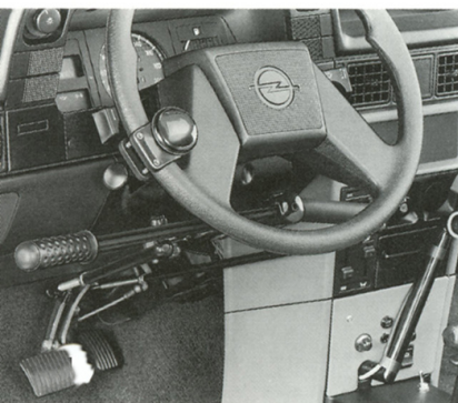
Oben: Kadett 1,3 S-Limousine mit Dachlifter. Per Knopfdruck wird der Rollstuhl über eine Schiene elektrisch auf das Dach gezogen, wo er unter einer Haube mitgeführt wird. Links unten: Hebel für Handbedienung von Gas und Bremse. Die Pedalfunktionen bleiben erhalten.
