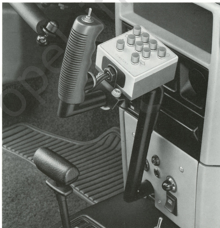
Oben: Kadett 1,3 S-Limousine mit Dachlifter. Per Knopfdruck wird der Rollstuhl über eine Schiene elektrisch auf das Dach gezogen, wo er unter einer Haube mitgeführt wird. Links unten: Hebel für Handbedienung von Gas und Bremse. Die Pedalfunktionen bleiben erhalten.
