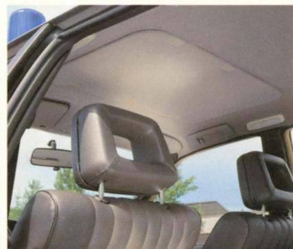
Rechts unten: Deckenverkleidungen mit Montageöffnung gewährleisten Zugriff zu den elektrischen Anschlüssen der Dachaufbauten. Links: Das Funkgerät und die Bedienelemente der Warnanlage werden griffungünstig in das ergonomisch gestaltete Cockpit integriert.
