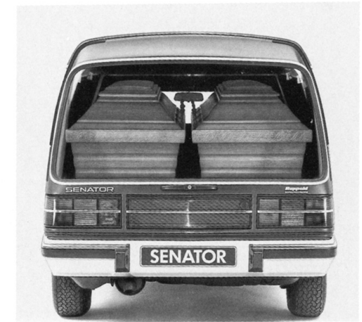
Zum Transport von zwei Särgen mit 1450 mm Ladebreite in 400 mm Höhe.
