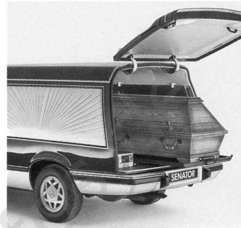
Zum Transport von einem Sarg mit 1390 mm Ladebreite in 400 mm Höhe.
