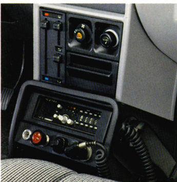
Links oben: Der Kadett LS auf der Fahrt zum Einsatzort. Die Tonfolgeanlage mit 4 Starktonhörnern befindet sich im Motorraum. Links unten: Das Funkgerät und die Bedienelemente der optischen und akustischen Warnanlage werden für Fahrer und Beifahrer leicht erreichbar in die Mittelkonsole eingebaut.
