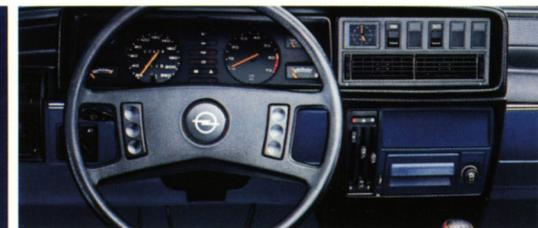
4-Speichen-Komfortlenkrad, Drehzahlmesser, Öldruckmesser, Voltmeter
