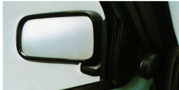
Von innen einstellbarer Außenspiegel
