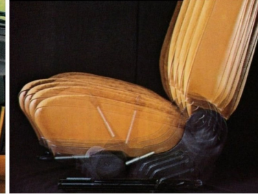
Die Höhenverstellung des Fahrersitzes ermöglicht optimale und schnelle Anpassung an Fahrer auch sehr verschiedener Statur.
