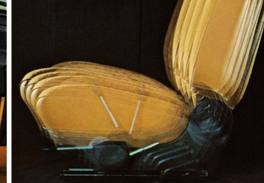
Die Höhenverstellung des Fahrersitzes ermöglicht optimale und schnelle Anpassung an Fahrer sehr verschiedener Statur.
