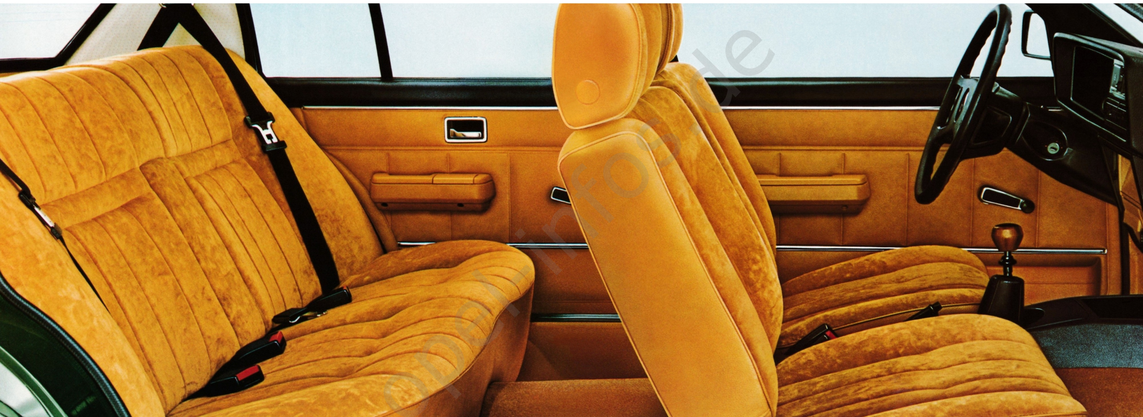
Die Höhenverstellung des Fahrersitzes ermöglicht optimale und schnelle Anpassung an Fahrer sehr verschiedener Statur.
