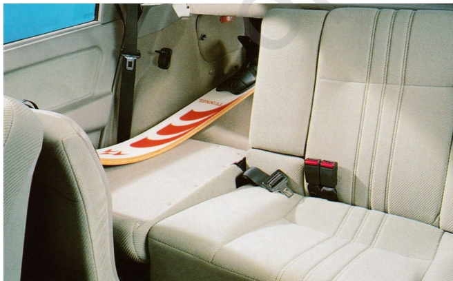
Asymmetrisch geteilte, umklappbare Rücksitzbank mit Durchladeeinrichtung.
