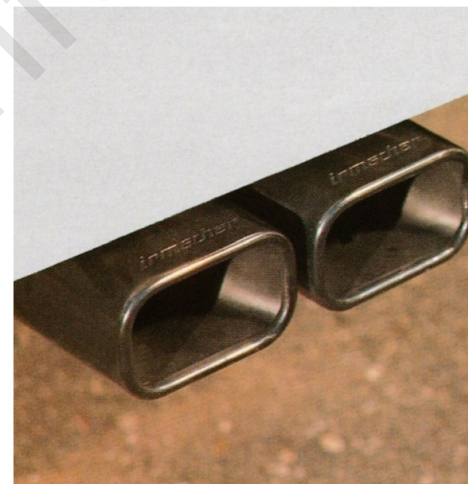
Nachschalldämpfer mit rechteckigem Doppel-Endrohr.
