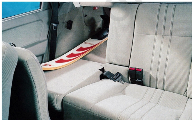
Asymmetrisch geteilte, umklappbare Rücksitzbank mit Durchladeeinrichtung.
