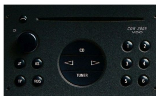
■●▲ Radio CDR 2005: Stereo-CD-Radio mit sechs Stationstasten, Auto Store, Verkehrsfunk, erweitertem RDS-EON, geschwindigkeitsabhängiger Lautstärke-Regelung und einstellbarer Verkehrsfunklautstärke.
