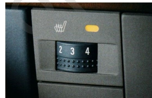
■●▲ Angenehme Wärme für kalte Tage. Die Sitze können auf Wunsch sowohl vorn als auch hinten mit einer 5-stufigen Sitzheizung ausgerüstet werden.
