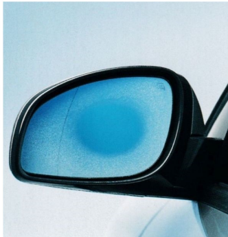
Bei jedem Wetter beste Sicht nach hinten. Die elektrisch einstell- und beheizbaren Außenspiegel.
