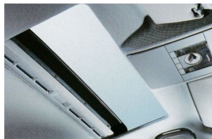
■●▲ Das elektrische Schiebe-/Ausstelldach mit Positionsvorwählschalter und Einklemmschutz lässt sich auch per Fernbedienung öffnen und schließen.
