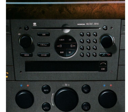
■●▲ Hightech-Alternative. Die hochpräzise Klimatisierungsautomatik mit Temperaturvorausrechnung und getrennter Regelung für Fahrer- und Beifahrerseite. Spezielle Funktionen werden über das monochrome Graphic Info Display (GID) oder optional über das farbige Color Info Display (CID) eingestellt.
