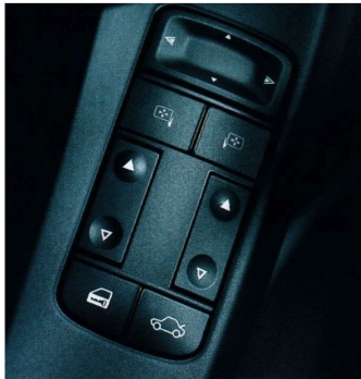
Über die in der Fahrertür platzierte Schaltkonsole haben Sie die Steuerung der wichtigsten elektrischen Komfortfunktionen bequem im Griff.
