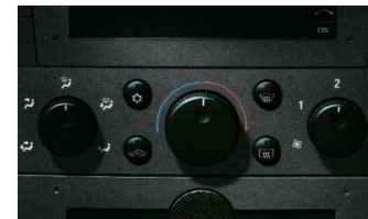
■□△ Serienmäßig ab dem Vectra Comfort. Die FCKW-freie Klimaanlage mit manueller Umluftschaltung und Partikelfilter.
