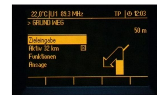
■●▲ Alle Navigationssysteme verfügen über eine dynamische Routenführung. Die Anzeige erfolgt als Symboldarstellung auf dem monochromen Graphic Info Display (GID) bzw. auf Wunsch auch als Kartendarstellung auf dem farbigen Color Info Display (CID).
