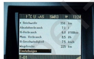
■●▲ Der Bordcomputer versorgt Sie mit allen erforderlichen Informationen, z. B. über Kraftstoffverbrauch, Reichweite oder Durchschnittsgeschwindigkeit.
