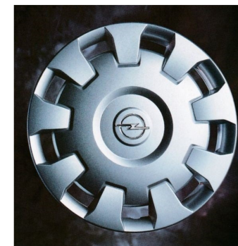
Die Stahlräder 6½ J x 16 mit ganzflächigen Radabdeckungen. Die Reifen haben die Größe 215/55 R 16.
