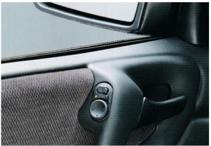
Elektrische Außenspiegel, von innen einstell- und beheizbar.
