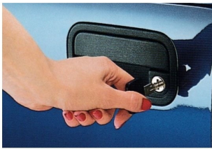
Zentralverriegelung mit Diebstahlsicherung. Verriegelt Türen, Tankdeckel und Kofferraum.
