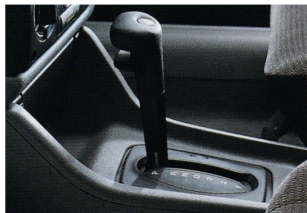
Opel 4-Gang-Automatik mit vollelektronisch gesteuertem Getriebe und intelligenter Schalttechnik mit drei Fahrprogrammen.
