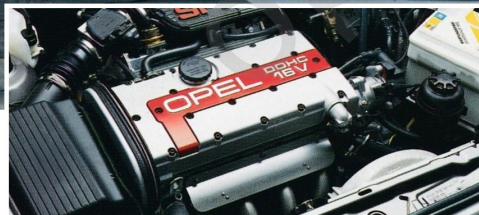
Das 2.0i-16V-Triebwerk mit 110 kW (150 PS).
