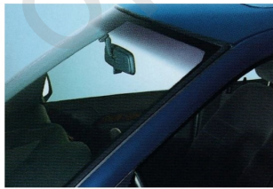
Wärmeschutzverglasung. Grüngetönte Rundumverglasung mit zusätzlichem Bandfilter an der Frontscheibe.
