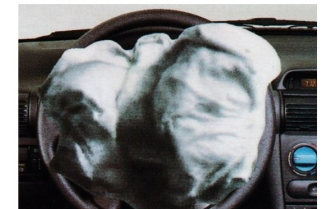
Im Bruchteil der Zeit, die ein Mensch für einen Augenaufschlag benötigt, öffnet sich der Airbag und ...
