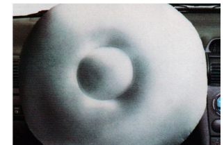
... ist etwa 40 bis 50 Millisekunden nach einem Frontalaufprall voll entfaltet.
