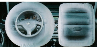
Seine Größe macht ihn so sicher: der Opel Full Size Airbag mit 67 Liter Volumen auf der
