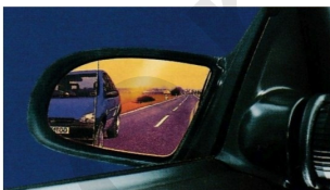
Das ganze Verkehrsgeschehen im Blick. Weitwinkel-Spiegeleinsatz mit asphärischem Spiegelglas.
