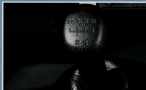
Nach wirtschaftlicher schalten: Das 5-Gang-Getriebe senkt Verbrauch, Drehzahl und Verschleiß (nicht in Verbindung mit 1.3 S-OHC-Motor).
