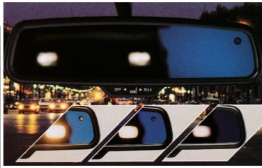
Der automatisch abblendbare Innenspiegel, 17 04 741, ist eine Neuheit: Ein lichtempfindlicher Sensor reagiert, wenn aufgeblendete Scheinwerfer nahen, und blendet dann automatisch ab. Die Empfindlichkeit des Sensors lässt sich in zwei Stufen regeln.
