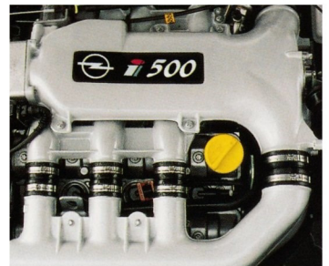
Sechs Zylinder, 24 Ventile: Das ergibt hohe Laufkultur, effiziente Verbrennung, reduzierte Schadstoffemission und dieses Super-Drehmoment: 240 Nm bei 3500 U/min.
