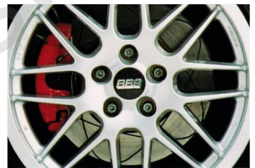
Zum sportlichen Fahren gehört eine zuverlässige Bodenhaftung durch breite Räder: BBS-Leichtmetallräder 7 1/2 J x 17 mit Bereifung 215/45.
