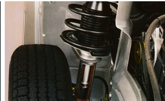
Federbein-Vorderrad-Aufhängung nach dem McPherson-Prinzip
