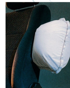
Die serienmäßigen Seitenairbags befinden sich bei jeder Sitzeinstellung immer in der idealen Schutzposition zum Fahrer bzw. Beifahrer. Die Auslösesensoren sitzen dort, von wo die meiste Gefahr
