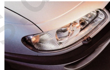
Mehr Licht für den Omega, bessere Sicht für den Fahrer: Xenon-Scheinwerfer mit dynamischer Leuchtwertenregulierung und Scheinwerfer-Hochdruck-Reinigungsanlage.
