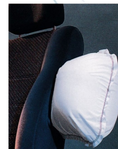
Die serienmäßigen Seitenairbags befinden sich bei jeder Sitzstellung immer in der idealen Schutzposition zum Fahrer bzw. Beifahrer. Die Auslösesensoren sitzen dort, von wo die meiste Gefahr droht: in den vorderen Türen.
